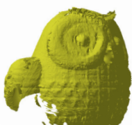
Результат сканирования полупрозрачного объекта.
