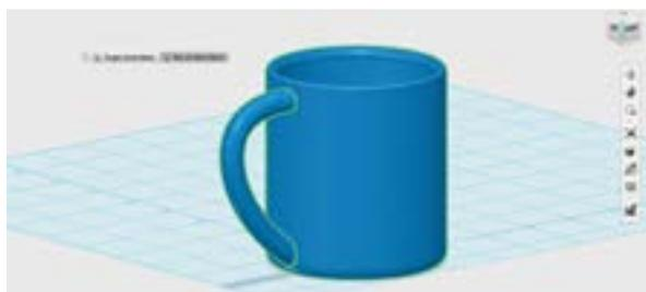
Если файл оригинального дизайна получить невозможно, тогда попробуйте импортировать STL или OBJ файл в специальной программе для устранения ошибок, например, в Autodesk MeshMixer. MeshMixer имеет много инструментов для анализа и восстановления. Доступны также и другие похожие программы такие, как Netfabb и MeshLab.
