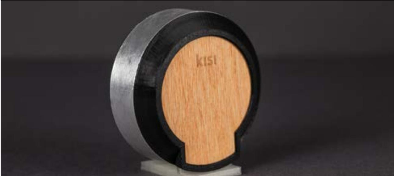
Электронный замок Kisi располагается внутри распечатанного на 3D принтере корпуса.
